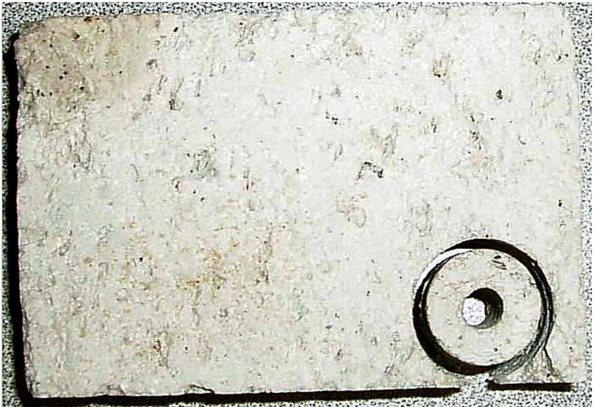
Figura 7: Perforación realizada en la piedra pómez
